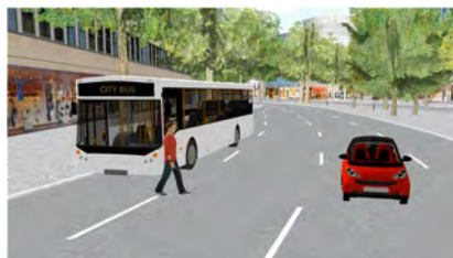
⑤ „Virtuelle Realität“ für Fahrdynamikprogramme zum Test von Fahrerassistenzsystemen
