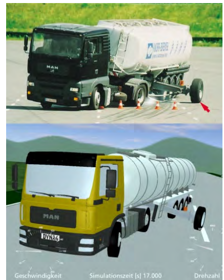
❶ LKW-Kippversuch. Vergleich der Simulation mit Fahrversuch in der Animation.
